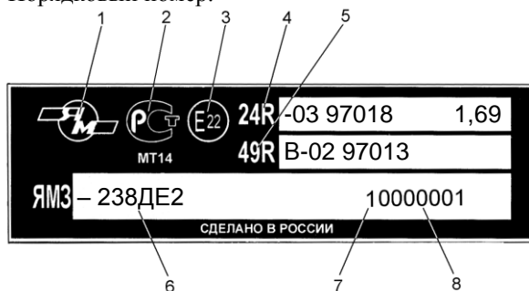
Рис. 49. Заводская табличка двигателя ЯМЗ-238ДЕ2.
